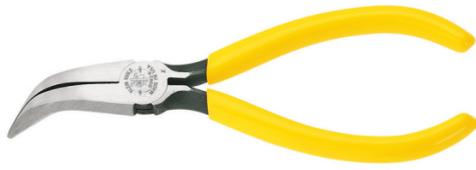
Las pinzas de punta curva de Klein Tools cuentan con una punta doblada a 70° para mayor versatilidad. Los mangos curvos proporcionan mayor control para trabajar en espacios reducidos. Las mordazas moleteadas ayudan a enrollar y enlazar cables. Fabricadas en acero forjado para brindar máxima durabilidad
