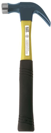
El martillo de uña curva de Klein Tools cuenta con una funda duradera de aleación plástica que ayuda a proteger el cuello del desgaste y astillado si se golpea incorrecta o excesivamente. Cuenta con una barra de fibra de vidrio de alta resistencia que absorbe los golpes y mantiene la cabeza firme. El martillo cuenta con un cómodo agarre de neopreno con perforaciones.
