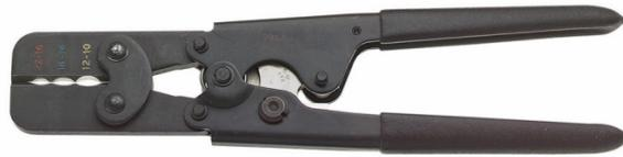
Poncha terminales aislados en cables de tamaños 22-16 (cavidad frontal), 16-14 (cavidad intermedia) y 12-10 (cavidad trasera). Cuenta con marcas de color indicadoras del tamaño de los cables. El trinchado de ciclo completo ejerce mayor potencia de ponchado en cada apriete.
