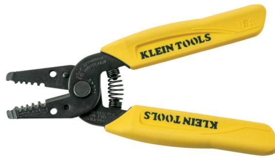
Esta liviana y compacta herramienta para pelar y cortar cables está diseñada para cortar cable sólido de 10-18AWG. Los agujeros peladores rectificadas a precisión cortan limpiamente cables y ayudan a quitar fácilmente el aislamiento. Su punta angosta permite que la herramienta llegue fácilmente a espacios estrechos.
