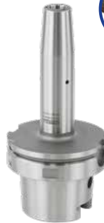
Coolant Port Option - DIN69893A / DIN 69882-8
