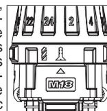
Bien réglé, l'embrayage réglable glisse à un couple pré-réglé pour éviter de visser trop profondément dans différents matériaux et pour éviter d'endommager la vis ou l'outil.
