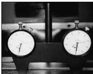
Remarque : Il n'est pas nécessaire que les aiguilles soient dirigées dans le même sens. Pour déterminer la perpendicularité, il faut se baser sur les affichages numériques identiques, et non pas sur la position des aiguilles.
