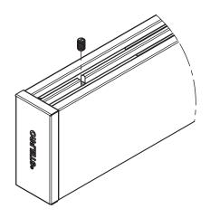
REMOVE THE SCREW FROM THE TOP OF THE UNIT IN ORDER TO SET THE TEMPERATURE ON THE TAMPERPROOF THERMOSTAT LOCATED INSIDE. REPLACE THE SCREW ONCE THE OPERATION IS COMPLETE.
