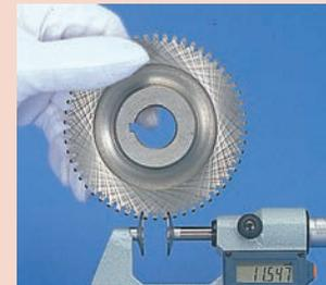
\*Les extrémités des disques de mesure sont en carbure.
