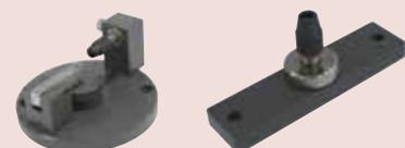
Utilisé pour sécuriser horizontalement un échantillon de fil ou d'aiguille d'un diamètre de 0,126"(3,2 mm) ou moins.
