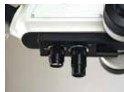
Avec revolver à glissière en option avec montage à 2 lentilles (option installée en usine)
