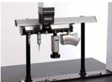
Remarque : si vous n'utilisez pas ACR3, le remplacement du palpeur doit être effectué manuellement.
