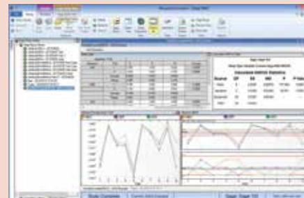
En plus des calculs standards, ce logiciel fournit également des outils graphiques pour l'analyse du système de mesure. Le graphique barre X et R peut montrer si la mobilité d'un appareil de mesure permet d'enregistrer les variations d'une pièce à l'autre et la cohérence des opérateurs. La représentation graphique « pièce en fonction de l'inspecteur » peut montrer un manque de cohérence entre les techniques d'inspection de l'opérateur.
