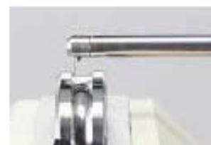
Profil intérieur/extérieur d'un roulement
