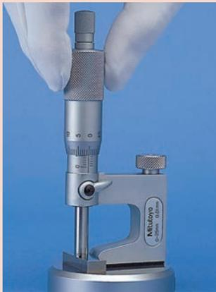
Avec la touche fixe de type disque (950758). Ci-dessus, le micromètre Uni-Mike est utilisé pour la mesure d'une hauteur.
