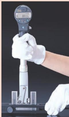
Jeu de cales d'étalonnage avec réglage d'origine
