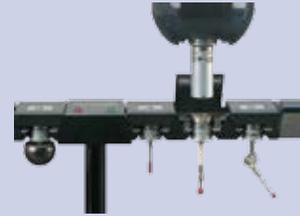
Le SCR200 permet un changement automatique à haute vitesse allant jusqu'à six modules de stylet TP200 (CNC CMM seulement). Le SCR200 est alimenté par l'interface de palpeur séparée, PI 200, et fournit des fonctionnalités pour faciliter le changement sécuritaire du stylet.
