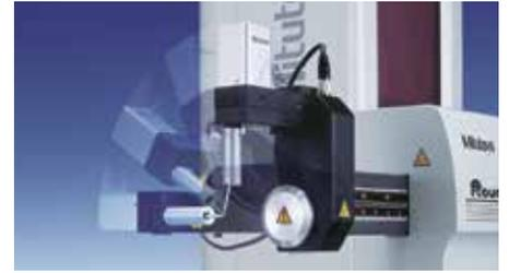
Basculement de l'orientation du bras support (position verticale - position horizontale)
