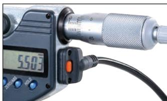
La sortie des données est possible avec un câble de connexion étanche.
