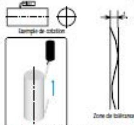
Exemple de vérification à l'aide d'un instrument de mesure de la rectitude
