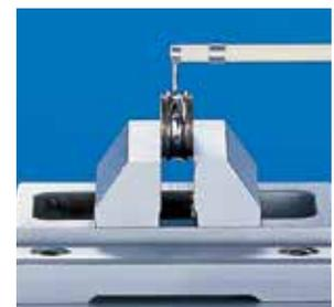
Mesure d'une bague de roulement
