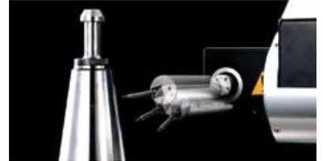
Mécanisme de rotation du détecteur (0 à 290°, par incréments de 1°)
