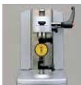
Utilisation du jeu de pièces de fixation du comparateur de contrôle (02ASK000)
