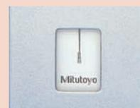
Pour les pièces souples, la prise de mesure s'effectue lorsque l'aiguille est entre les deux traits de l'index.
