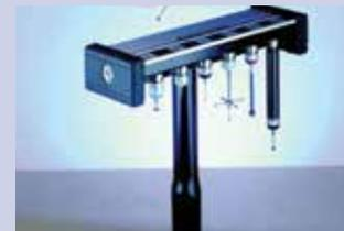
Le rack de stockage manuel MSR1 tient jusqu'à 6 ensembles de stylets préqualifiés et adaptés aux modules de palpeur TP20 ou TP200 afin de simplifier le changement manuel du module. Le MSR1 peut être monté sur la table CMM ou sur une surface verticale.
