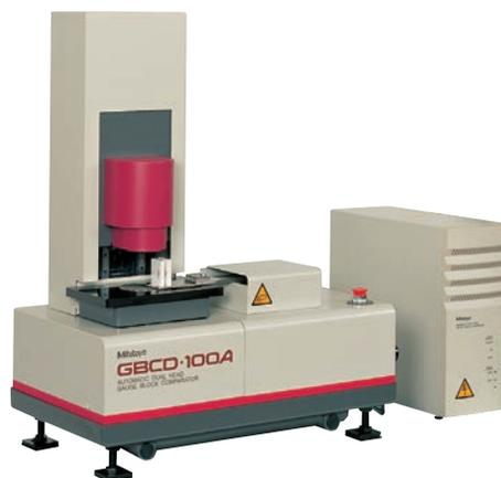
Le comparateur de calibres étalon automatique GBCD-100A est un système de contrôle des calibres étalons de type à deux têtes et d'utilisation facile. Il compare automatiquement les pièces avec un calibre étalon standard et détermine la précision d'éléments tels que la longueur centrale, la longueur maximale, la longueur minimale et le parallélisme par l'intermédiaire d'un ordinateur personnel en option.
