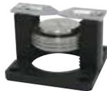
Utilisé pour sécuriser un échantillon qui a une surface de mesure difficile à stabiliser, perpendiculaire à l'axe du pénétrateur.
