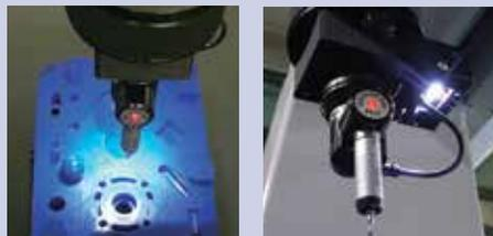
Éclairage du capteur (en option) pour éclairer le capteur, le stylet et le champ de travail
